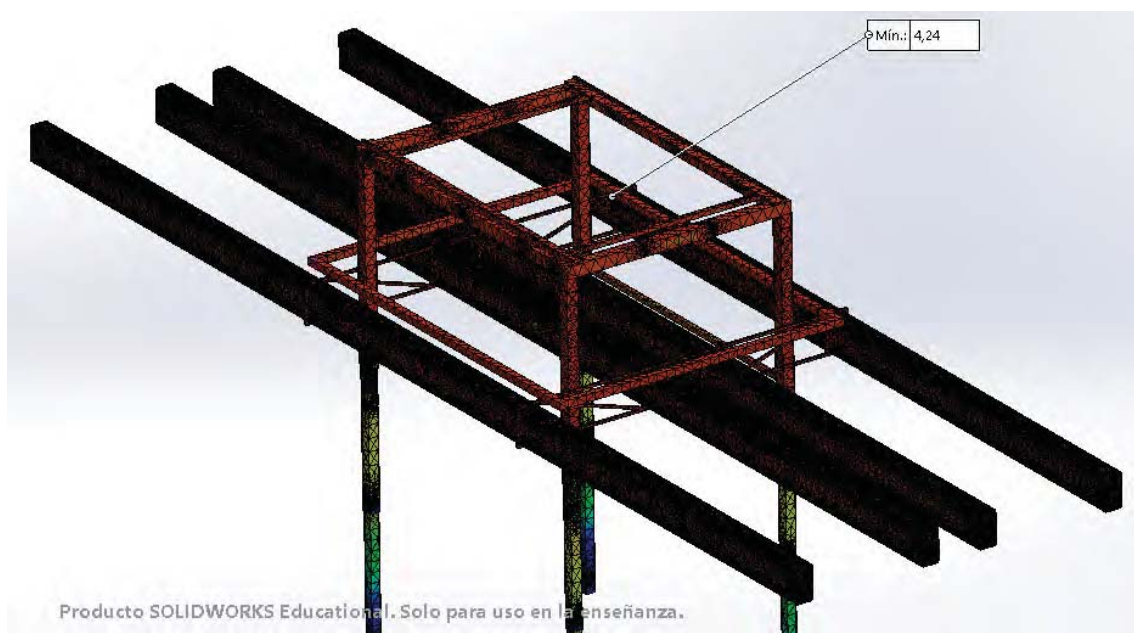
Figura D.17. Resultado del trazado de factor de seguridad. Fuente: Elaboración propia. SolidWorks
