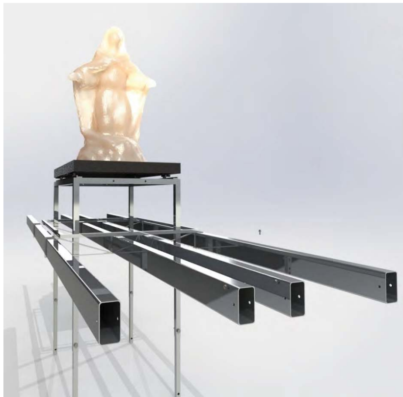
Figura D.1. Estructura metálica de las andas de traslado. Fuente: Elaboración propia. SolidWorks.
