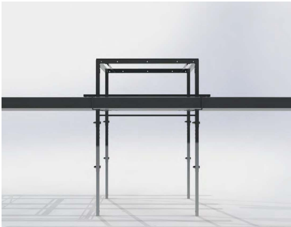
Figura C.19. Estructura de aluminio como andas de traslado. Fuente: Elaboración propia. SolidWorks.
