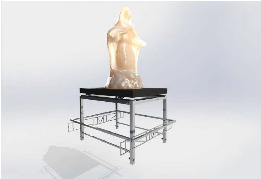
Figura C.20. Estructura de aluminio como peana de culto. Fuente: Elaboración propia. SolidWorks.
