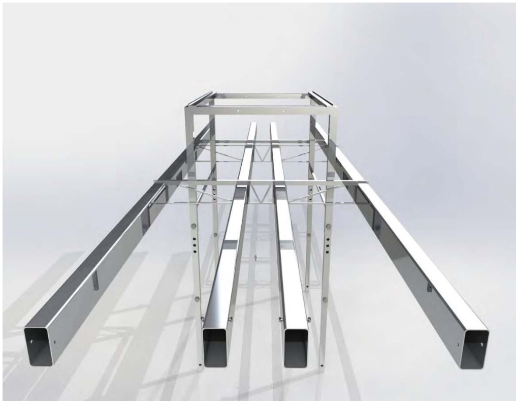
Figura C.18. Estructura de aluminio como andas de traslado. Fuente: Elaboración propia. SolidWorks.
