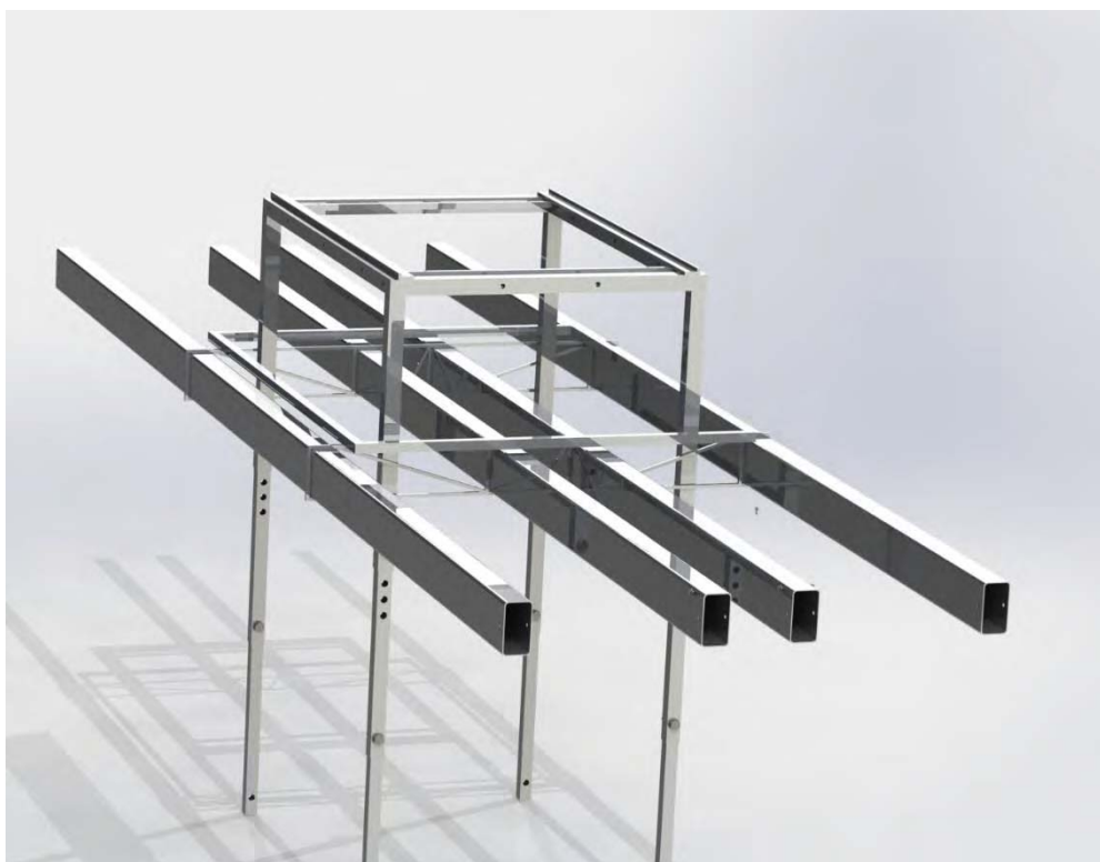
Figura C.16. Estructura de aluminio como andas de traslado. Fuente: Elaboración propia. SolidWorks.
